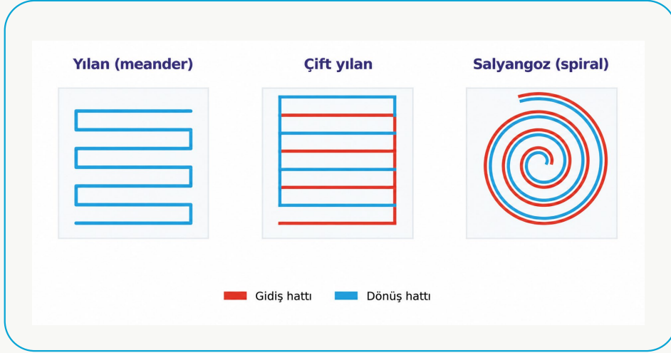
Şekil 2.3 Yaygın boru döşeme düzenleri
